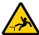
PERICOLO DI CADUTA
