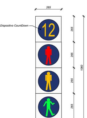
LANTERNA SEMAFORICA PEDONALE in policarbonato nero modello "Galileo" completa di ottiche Starled 2 ad elevata luminosità composta da tre moduli componibili R-G-V Ø 200 mm, parasole ad innesto rapido su 3 punti, cablaggio elettrico.
