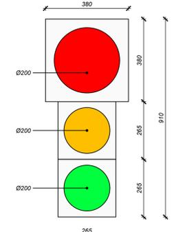
LANTERNA SEMAFORICA in policarbonato nero modello "Galileo" completa di ottiche Starled 2 ad elevata luminosità composta da tre moduli componibili R Ø300MM, G-V Ø 200 mm, parasole ad innesto rapido su 3 punti, cablaggio elettrico.
