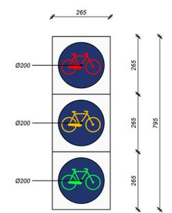
LANTERNA SEMAFORICA CICLO in policarbonato nero modello "Galileo" completa di ottiche Starled 2 ad elevata luminosità composta da tre moduli componibili R-G-V Ø 200 mm, parasole ad innesto rapido su 3 punti, cablaggio elettrico.
