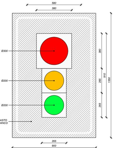
LANTERNA SEMAFORICA in policarbonato nero modello "Galileo" completa di ottiche Starled 2 ad elevata luminosità composta da tre moduli componibili R Ø300MM, G-V Ø 200 mm, parasole ad innesto rapido su 3 punti, cablaggio elettrico. Completo di pannello di contrasto, asta e incolore.
