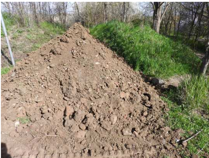
Foto n.33 – Particolare terreno sondaggio a -2.60m.
