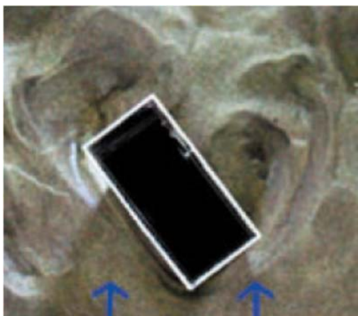
Figura 24: Esperimento di laboratorio, Dipartimento di Idraulica, Università di Pavia. Vista dall'alto di uno ostacolo rettangolare posto su letto sabbioso in seguito a simulazione.
