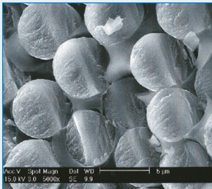
Microfotografia di un composito strutturale a matrice polimerica dal Laboratorio di Ricerca e Sviluppo MAPEI
