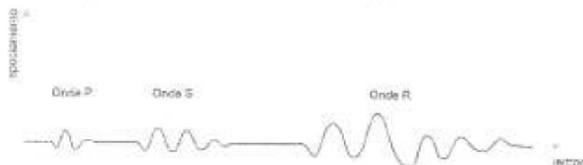
Fig. 1 : sismogramma che evidenzia l'arrivo distinto di onde P, S e di Rayleigh (da Crespellani e Faccionasso "Dinamica dei terreni")
